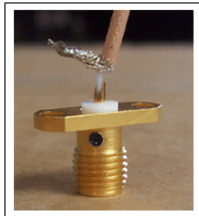
FIGURA 4.8: Imagen del conector SMA-hembra soldado al cable coaxial.
