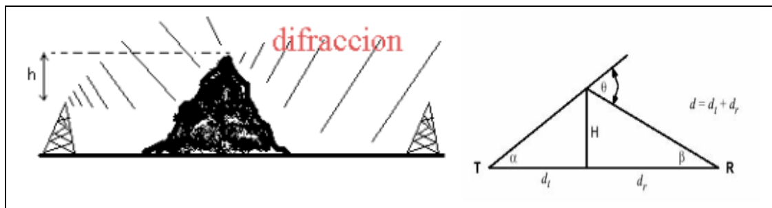
Figura 2.5: Fenómeno de difracción y esquema de transmisión.
